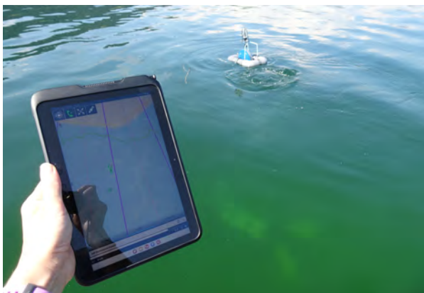
Auf der Transektlinie wird bei jeder Änderung der Vegetationsdichte und/oder -zusammensetzung eine Abschnittsgrenze gesetzt und per GPS eingemessen. Der Taucher gibt diese Grenze per Signal über Sprechfunk oder mit der Boje der Untersuchungsleitung für die Positionsmessung bekannt. Auch die vorgängig eingemessene Transektlinie ist auf dem Display ersichtlich, ebenso die ständige Position des Taucher. Damit kann die korrekte Einhaltung der Tauchstrecke überwacht werden.
