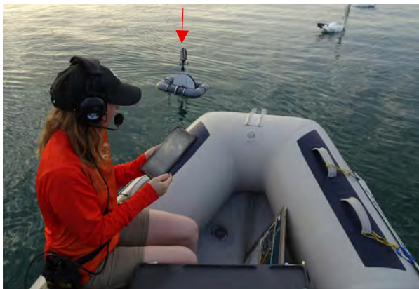
Begleitung des Tauchers mit dem Boot. Die Position des Tauchers ist mit der Boje ersichtlich (Pfeil). Über Sprechfunk kann die Untersuchungsleitung auf dem Boot mit dem Taucher kommunizieren.
